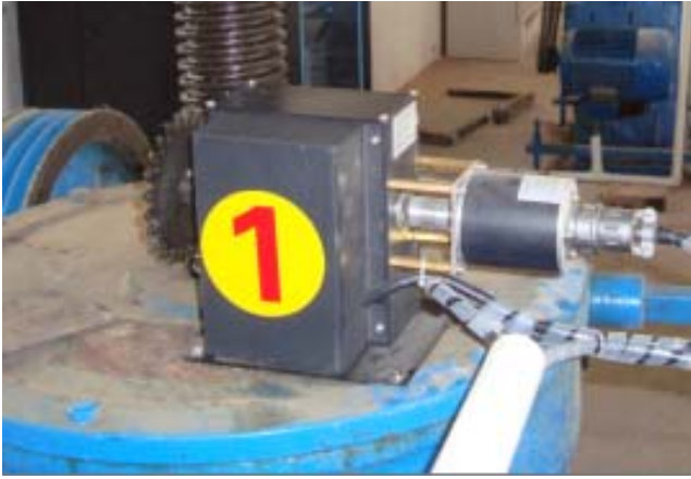
9、HZS 主令恒力收绳闸门开度传感器，螺杆式启闭机钢丝绳连接安装位置效果图：
