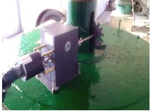
9、HZS 主令恒力收绳闸门开度传感器，螺杆式启闭机钢丝绳连接安装位置效果图：
