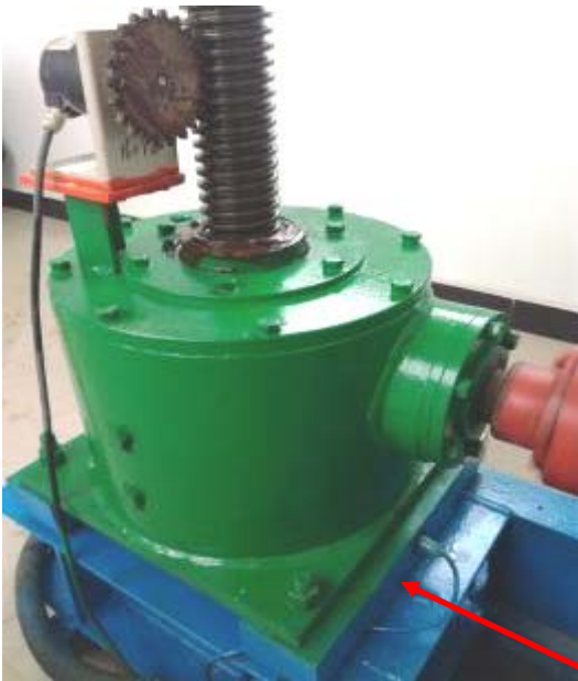
10、HZ-ZC 型轴承座式荷重传感器螺杆式启闭机安装位置图：
